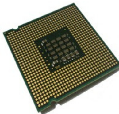
Figura 7: Vista inferior de um processador Pentium® 4.
