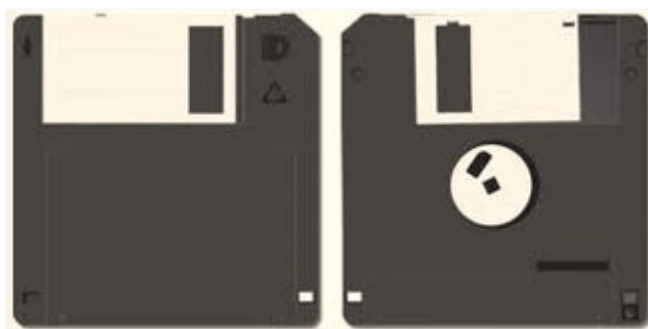
Figura 11: Frente e verso de um disquete de 3½ polegadas.
