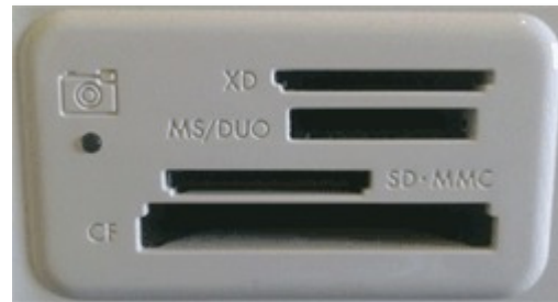
Figura 14: Entradas para cartão de memória no painel de uma impressora.
