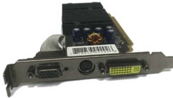
Figura 19: Uma placa de vídeo off board com saídas VGA, S-Video e DVI.
