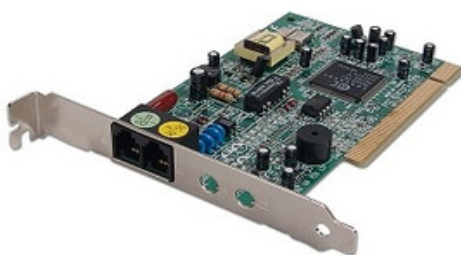
Figura 54: Uma placa de fax/modem interna utilizada para acesso discado. Um cabo é usado para conectar a saída da placa à tomada de telefone.
