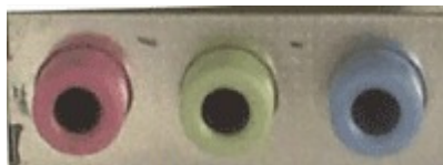
Figura 22: Saídas da placa de som onde são conectados o microfone e as caixas de som.
